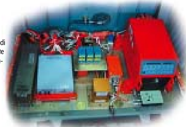
Rack della strumentazione FTI utilizzata sul nuovo SF-260EA
