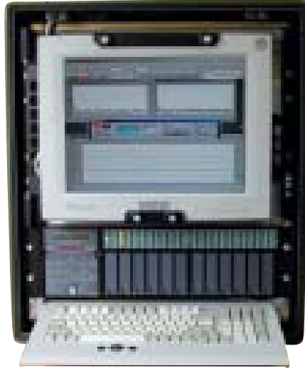
Esempio di stazione telemetrica trasportabile realizzata da Instrumentation Devices. Include: un doppio ricevitore RF, un computer integrato di demodulatore segnali e software di analisi real-time e un registratore digitale.
