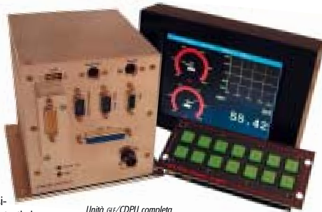
Unità GLE/CDPU completa di display grafico TFT da 6,5" e tastiera retroilluminata
