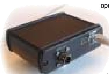
GLE/SmartZOC, sistema miniaturizzato di acquisizione e controllo per pressure scanner multipunto.
