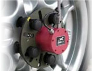
Sistemi di **Telemisura Wireless** su ruote: pressioni, temperature, strain, deformazioni, forza, RPM, vibrazioni.
