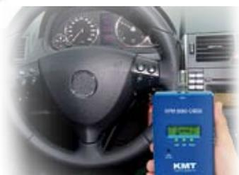
Misura di **giri motore e velocità veicolo** da **CAN-OBD2** (On-Board Diagnostics). Uscite in tensione e in frequenza di RPM e km/h.
