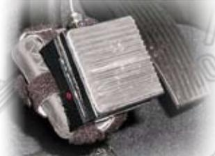
Sistema modulare per **installazione magnetica o a ventosa** di dispositivi di misura su ruote o corpo veicolo.
