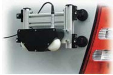
Sensori **Doppler** per misure senza contatto di **velocità al suolo e distanza** percorsa.
