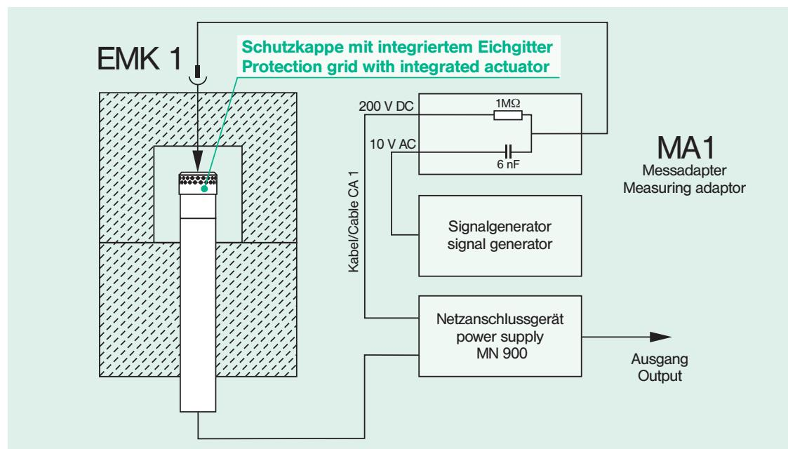
Bei den empfohlenen Spannungswerten 200 V DC und 10 V AC Generatorsignal und einem Übertragungsfaktor des Mikrofons von 50 mV/Pa beträgt die Ausgangsspannung des Messmikrofons etwa 5 mV bei einem Klirrfaktor von 2 %; das entspricht einem Schalldruck von 74 dB.
