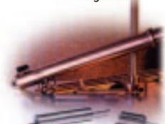
**Eddy Current** per misure di prossimità senza contatto, sono l'ideale per spostamenti e vibrazioni su organi rotanti. Fino a 12mm di fs risposta dalla DC a 10kHz.
