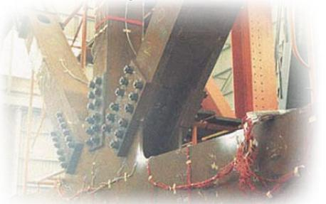
Misura delle deformazioni ad Alta Temperatura
