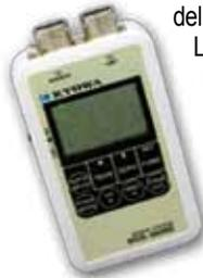
La sezione di uscita consente la verifica di condizionatori estensimetrici tramite la simulazione di un ponte di misura, con sensibilità variabile da 0.000 a  $\pm 5.000$  mV/V in passi da 0.010 mV/V (da 0 a  $\pm 10000$   $\mu$  in passi da 10  $\mu$ ).
