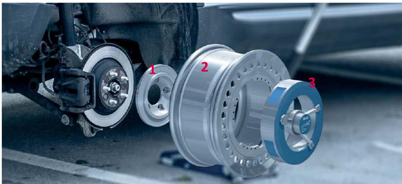
**1 Adattatore mozzo ruota:** l'adattatore del mozzo ruota collega il trasduttore WFT-C<sup>x</sup> al veicolo. Fino a che la configurazione del cerchio bulloni e l'offset della ruota sono i medesimi, può essere utilizzato per diversi tipi di veicolo. Con pochi adattatori, un intero parco veicoli può essere coperto.
